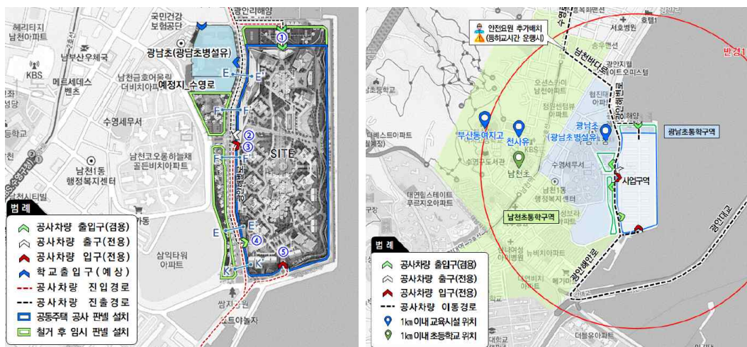
[그림 10] 공사차량 진출입구 및 이동경로 설정 사례2
