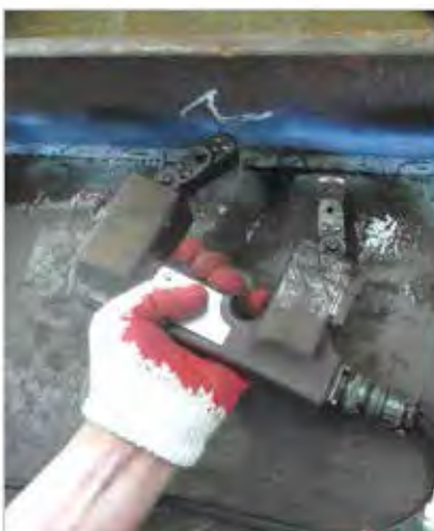
철골재료를 확인하기 위해 재료에 부착된 사양서, 마크를 확인할 뿐만 아니라 밀시트를 검토한다.
